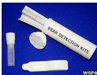
Bộ dụng cụ dùng test sự hiện diện chất albumin của gấu
