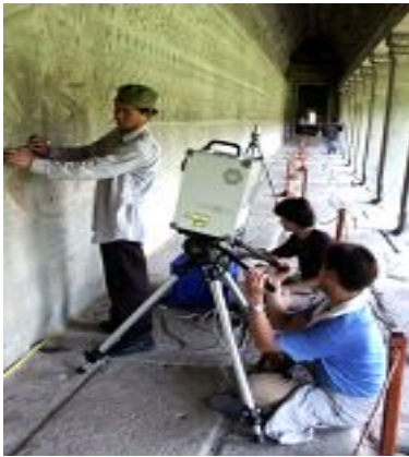
Pic 34. 캄보디아 앙코르와트 벽면부조(壁面浮彫) 3D스캔 작업중인 모습. 한번의 스캔으로 지상위의 최대 유적으로 불리우는 앙코르와트를 영원히 보존할 수 있게 된 것이다.
