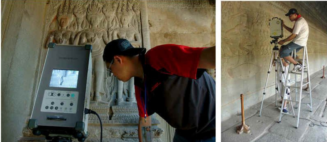
그림 7. 대상을 3차원으로 사진을 찍어 낼 수 있는 3D스캐너 .양코르왓 중앙탑의 압사라를 스캔받는(왼쪽) 모습과, 힌두신화 ‘우유바다 휘젓기’의 핵심인물인 ‘위슈누’를 경북전문대학교 한국전통문화콘텐츠센터 3D스캐닝팀이 작업하고 있는 모습으로 레이저로 빛을 쏘아 형상을 컴퓨터로 잡아낸다.
