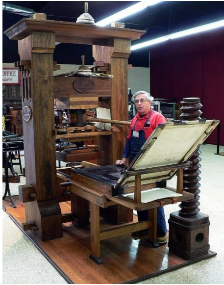
Hình 73: Mô tả máy in kiểu Gutenberg
